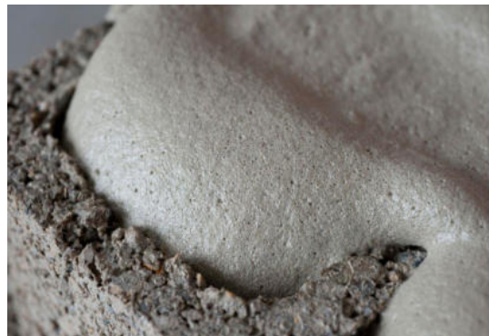
Abbildung 2: Foto einer Zelle eines Leichtbetonsteins, die mit Airium gefüllt wird (BlockFill-Anwendung) – Quelle: PERLMOOSER Beton GmbH
